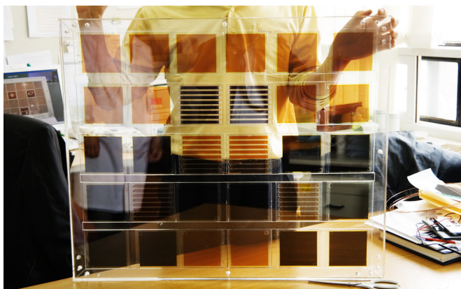
그림 1. 다양한 탄소나노튜브 염료감응형 태양전지 서브 모듈을 이용하여 제작한 태양전지 모듈 패널. 단일형, 패턴형, 투명형, 불투명형 등 전기연구원에서 개발한 다양한 형태의 모듈이 모두 포함되어 있다.
