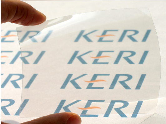
△ 탄소나노튜브 일액형 코팅액을 이용해 제조한 유연(flexible) 투명 전도성필름. 기존 ITO을 이용한 제조 방식에 비해 구부림이 가능하고 휴대가 편리한 형태로 제조가 가능해 향후 디스플레이 산업에 대한 활용도가 매우 높을 것으로 기대된다.
