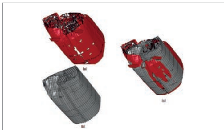
〈그림 3장-6-25〉 예측된 손상 결과와 실제 손상상태 비교 : 함수부(Bottom view)
