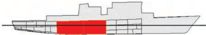
〈그림 부록 VI-4-1〉 2구획 침수 시 부양상태 계산 결과(Case 1)
