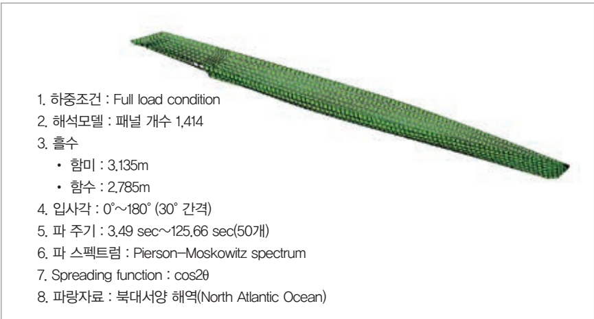
〈그림 부록 VII-3-1〉 3D 유체력 계산 모델 및 하중조건
