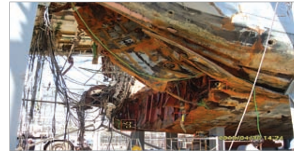
〈그림 부록 III-1-1〉 절단면의 시편 채취 위치
