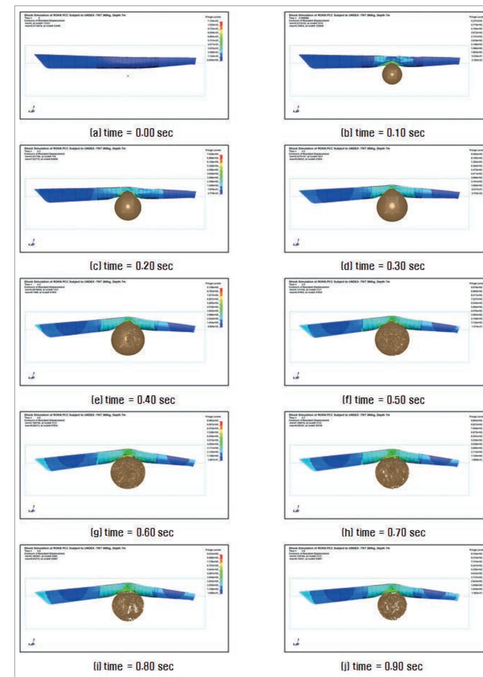
〈그림 3장-6-16〉 TNT 360kg이 수심 7m에서 폭발한 경우의 해석 결과 : Side view
