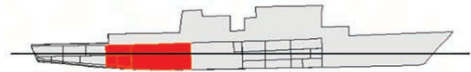
〈그림 부록 VI-4-3〉 2구획 침수 시 부양상태 계산 결과(Case 2)
