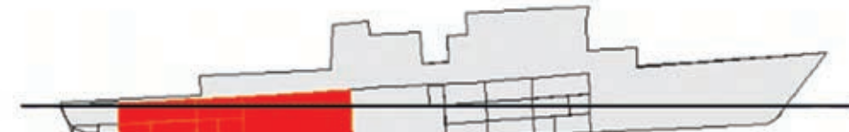
〈그림 부록 VI-4-4〉 3구획 침수 시 부양상태 계산 결과(Case 3)
